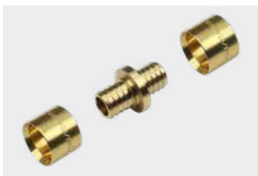
Rys. 49. Łącznik KAN-therm Push do rur PEXC, PERT i bluePERT o średnicach 12 × 2, 14 × 2, 18 × 2, 18 × 2,5, 25 × 3,5 mm.
